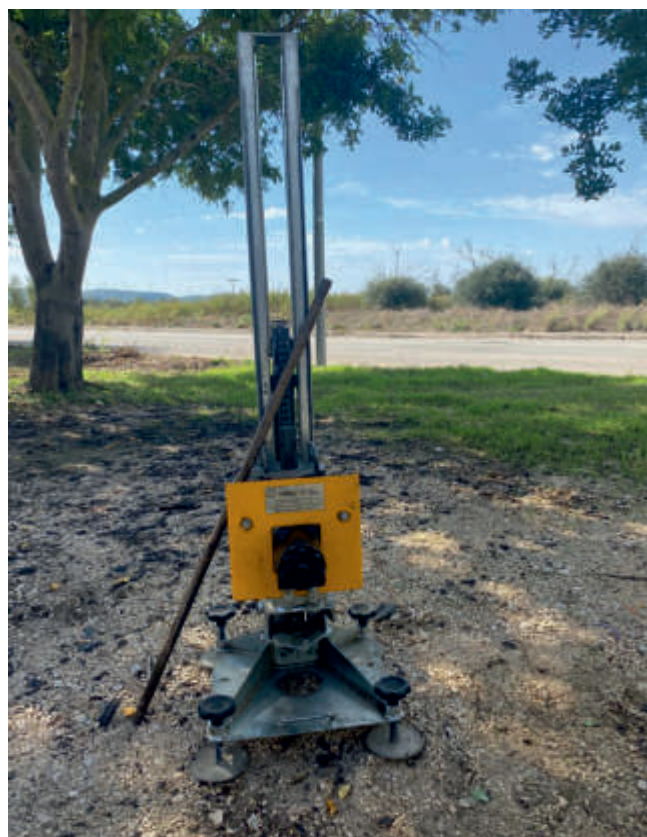
Foto n. 4 -- Fase esecuzione prova penetrometrica DL4
