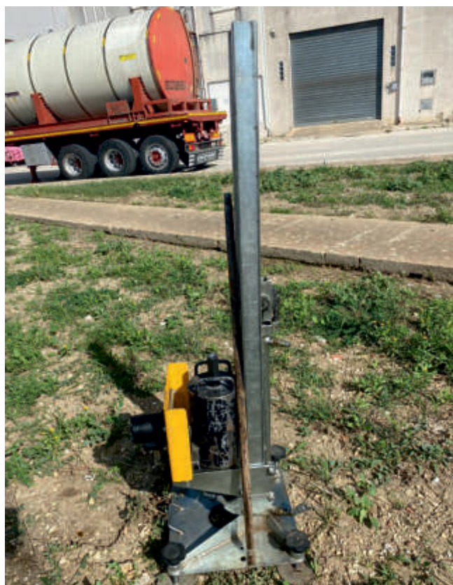
Foto n. 2 -- Fase esecuzione prova penetrometrica DL2
