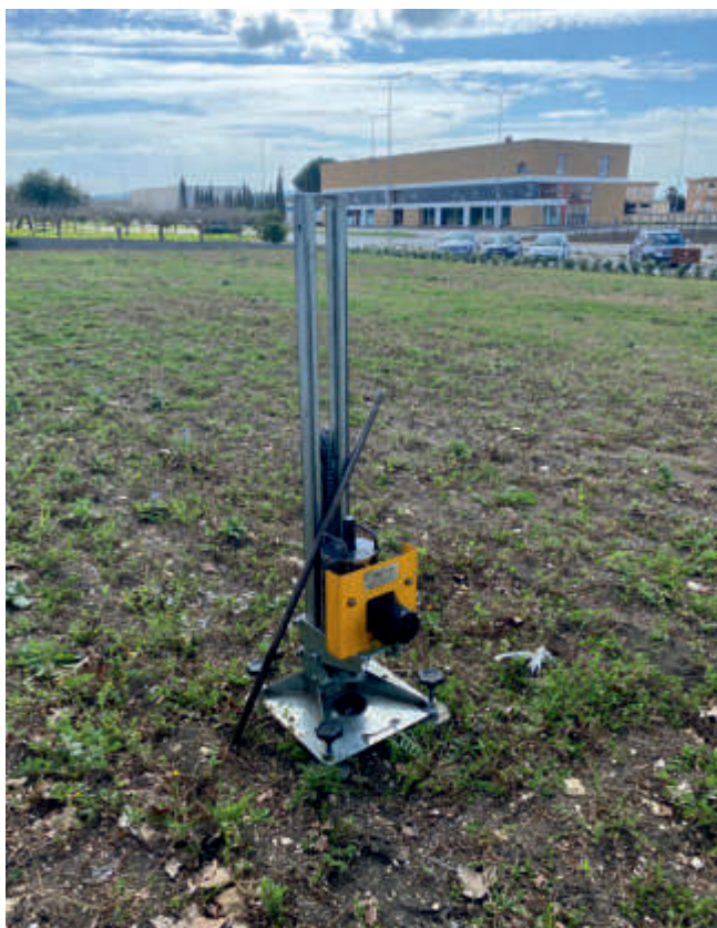
Foto n. 3 -- Fase esecuzione prova penetrometrica DL3
