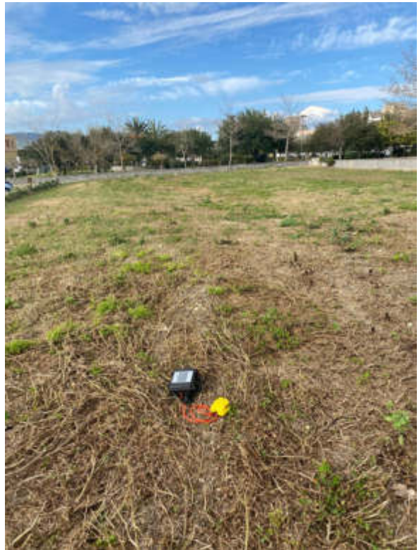
Foto 3 - Ubicazione indagine sismica tromografica HVSR(PIP1)
